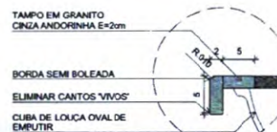
DETALHE 5 - CORTE Bancada de granito - cuba de embutir esc.: 1/5
