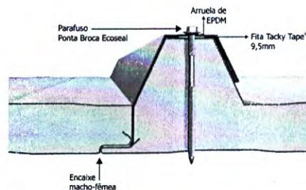
A fixação na onda alta garante a estanqueidade.
