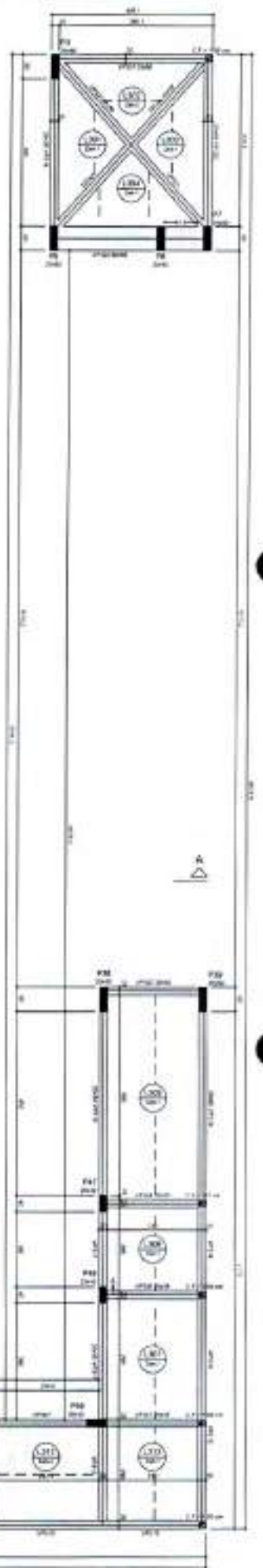
Forma do pavimento PLATIBANDA (Nível 525)
